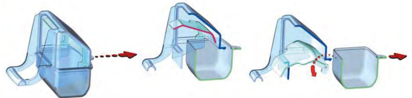
Simultaneamente all'estrazione del cassetto di alimentazione, si ha la chiusura di sicurezza che blocca il passaggio verso l'esterno.
